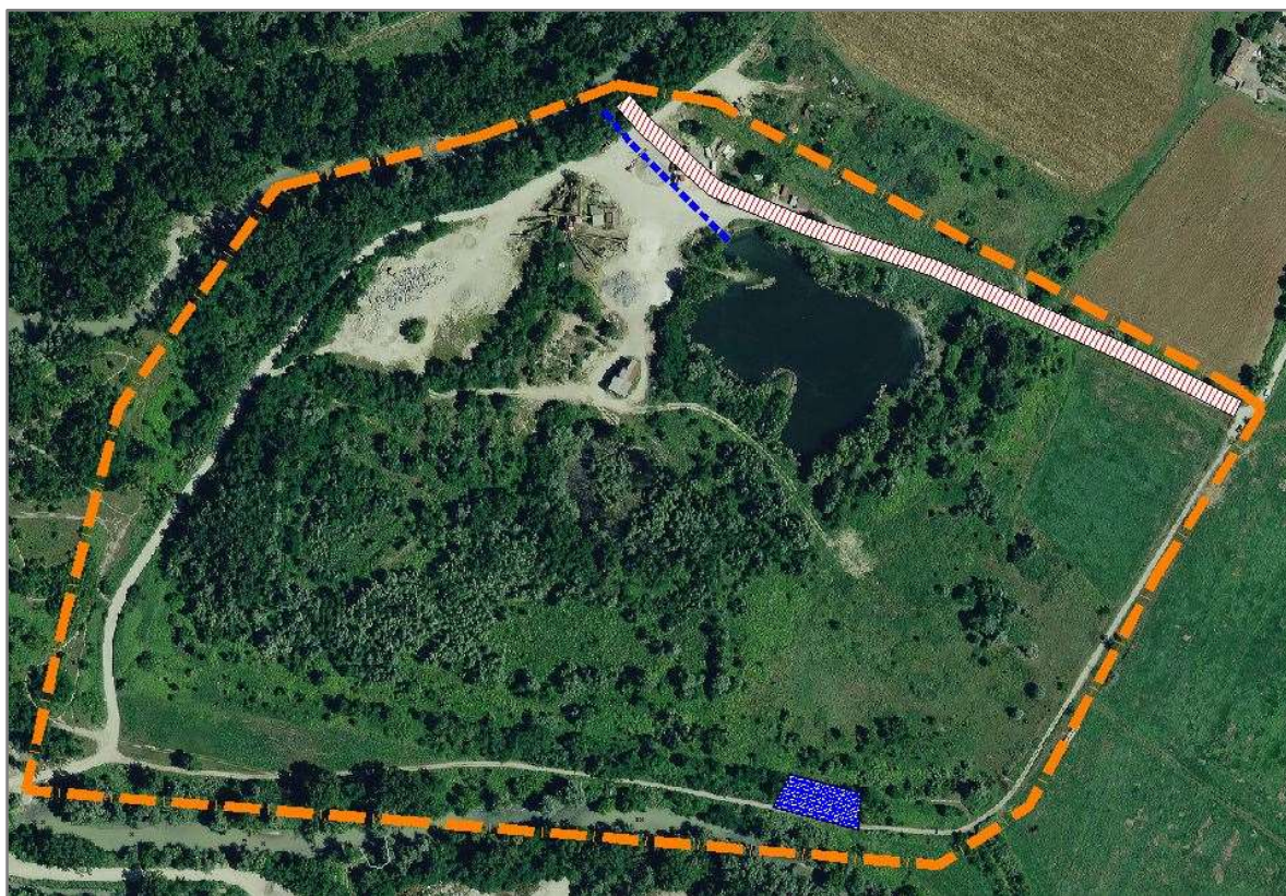
Figura 25 - Cassa di espansione in località Sa.Pi:Fo... in rosso la strada di accesso alla proprietà da rialzare; in basso (a monte dell'area), lo sfioratore; in alto (a valle) lo scarico di fondo.
