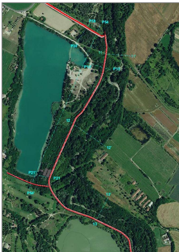
Figura 18 – Cassa di espansione in località Fo.Ma.: in rosso l'argine sx del fiume Ronco, l'argine del Rio Tibano e l'argine sud del lago, da rialzare; a destra del lago, in basso, lo sfioratore.
