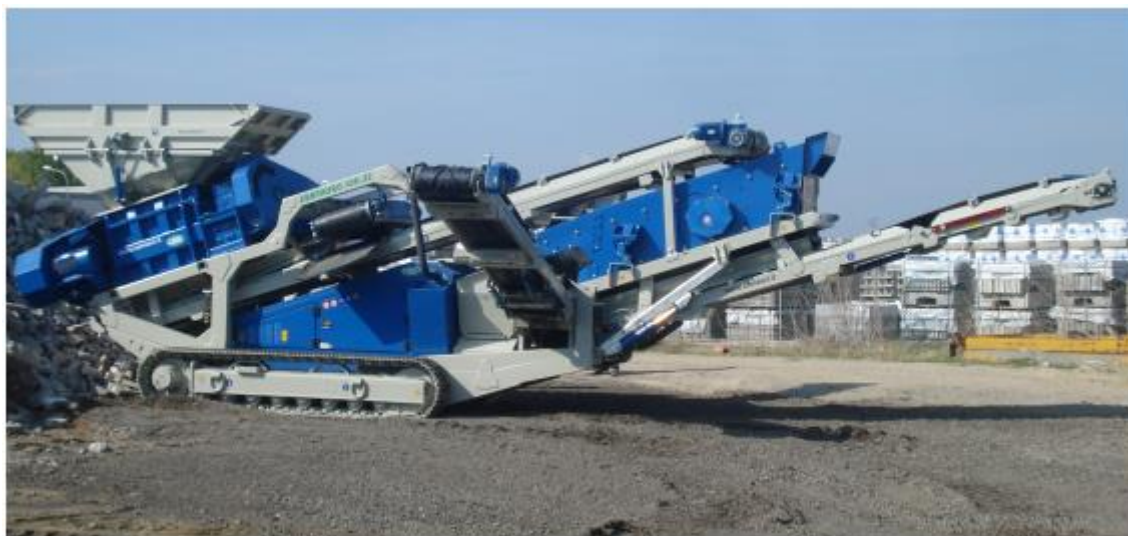
Figura 19: Trituratore mobile CAMS Centauro 100.32
