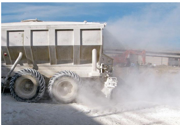
Figura 4.1- Esempio di stesa di ossido di calcio tradizionale
