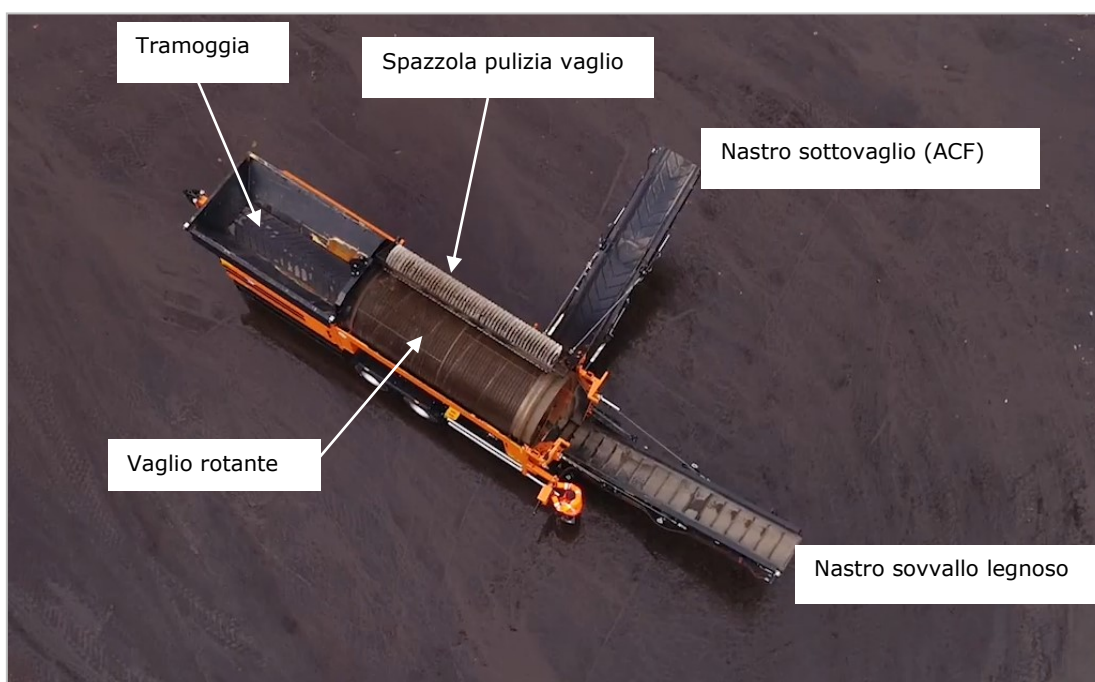
Figura 7: Descrizione vaglio mobile
