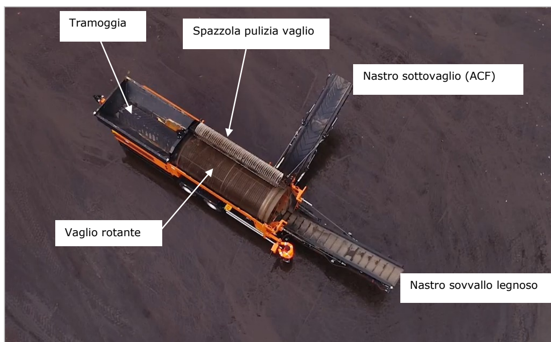
Figura 30: Descrizione vaglio mobile
