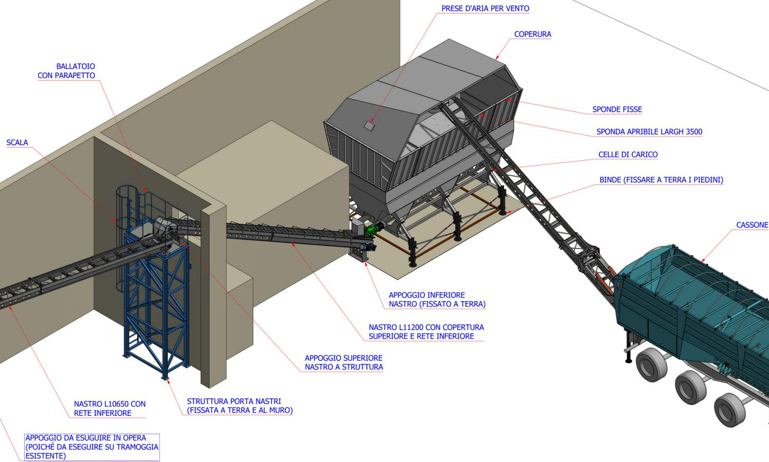
W.I.P. 2: ALLARGATO SPONDA APRIBILE A 3500, POSIZIONATO L'INGOMBRO VASCA A 5900 DA PARETE. INVERTITO POSIZIONE MOTORIDUTTORE DEL NASTRO INCLINATO PER MANUTENZIONE. ALLUNGATO IL NASTRO INTERNO PER ARRIVARE AL CENTRO DELLA TRAMOGGIA, AGGIUNTO INDICAZIONE RETI SOTTO NASTRI
