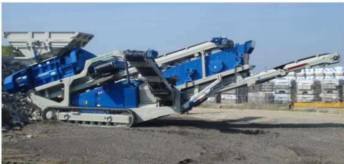
Figura 23: Trituratore mobile CAMS Centauro 100.32
