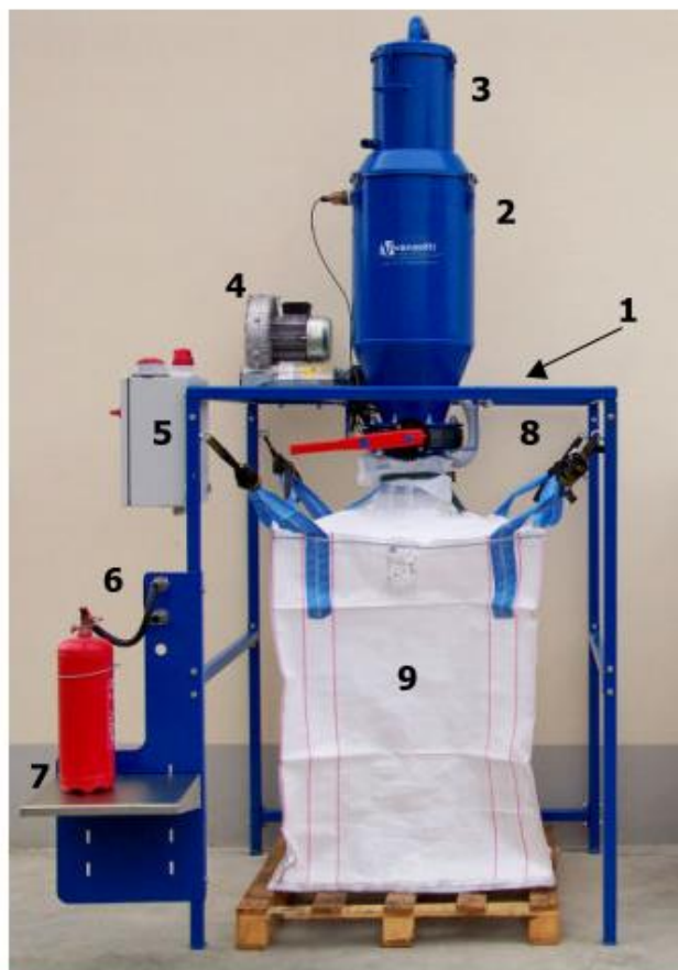
Recupero di estintore portatile pressurizzato
