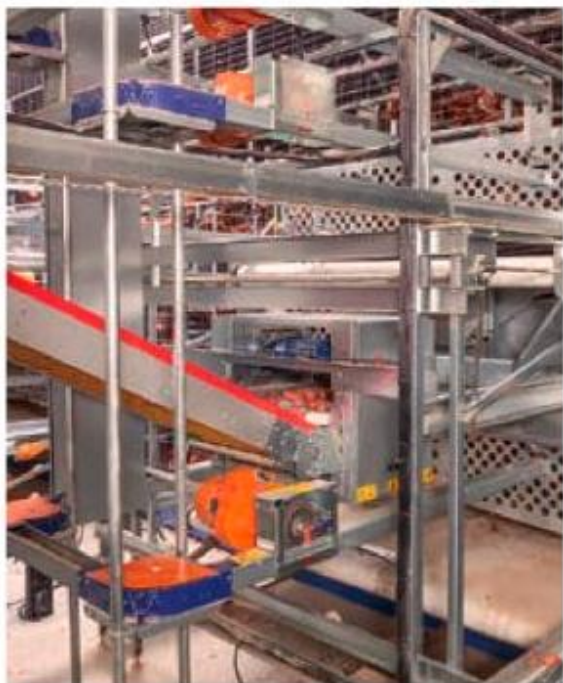
Raccolta uova con un trasportatore verticale e sistema di raccolta uova automatico con elevatore
