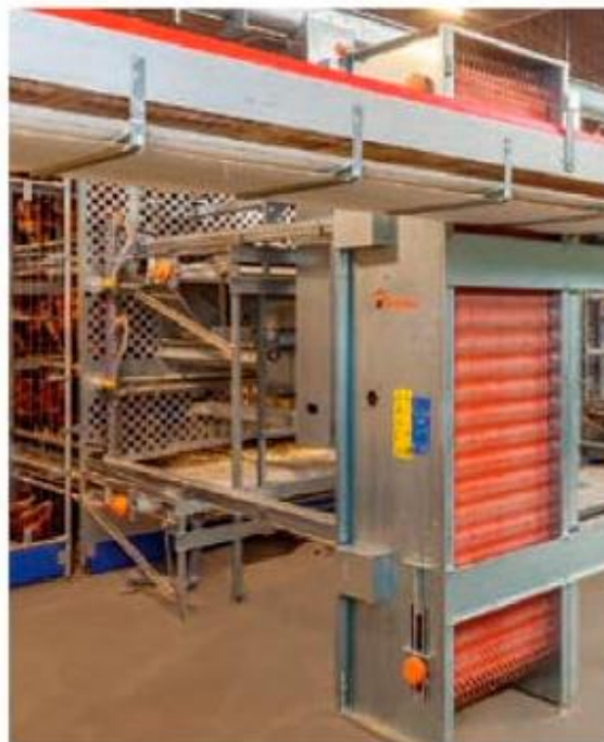
Raccolta uova con un trasportatore verticale e sistema di raccolta uova automatico con elevatore
