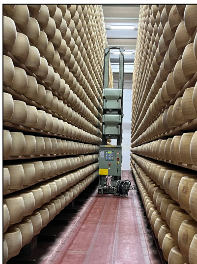
Figura 1.11: Macchina automatica volta-pulitrice
