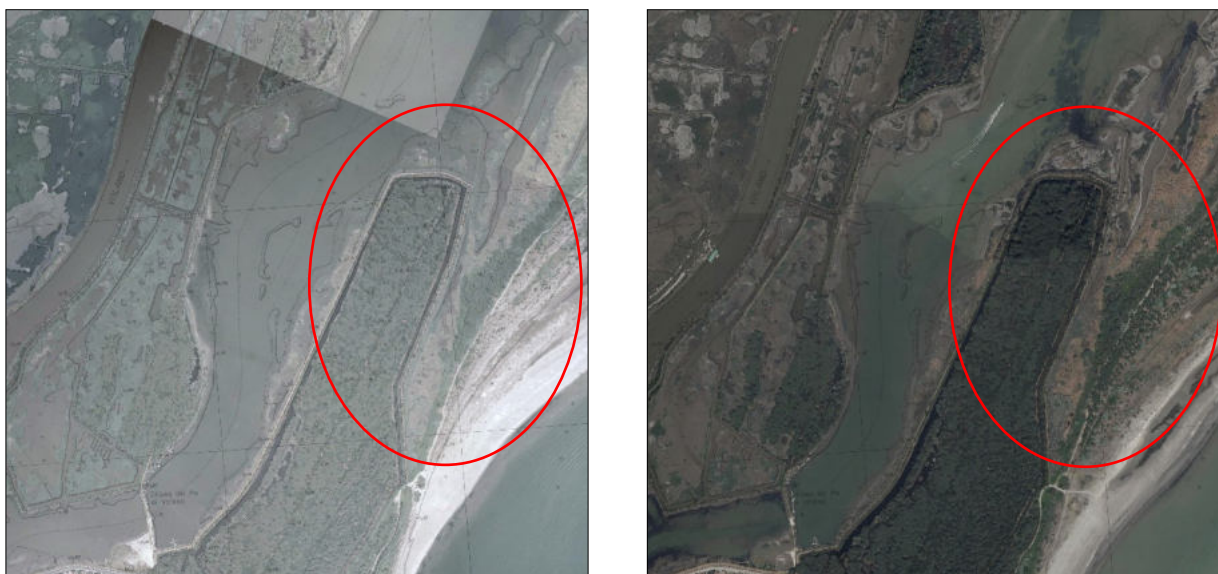
Fig.6 –Riprese aeree Costa 2005 (sx) e Agea 2017 (dx). Apparente stabilità delle zone prospicienti e notevole aumento dello Scannone.
