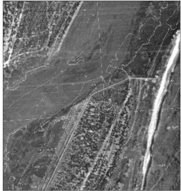
Fig.1 – Confronto tra la restituzione fotogrammetrica della situazione attuale (rilievo 2019) con il rilievo del 1954 (volo GAI) su base CTR 1:5.000 di riferimento.
