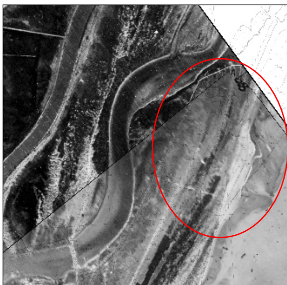
Fig.3 –Riprese aeree RAF 1943-44 (sx) e GAI 1954 (dx). L'argine a nord ha un diverso tracciato che lo collega con la spiaggia.
