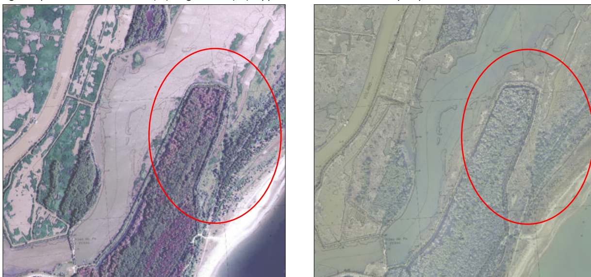
Fig.7 –Riprese aeree CGR 2018 (sx) e Distretto Po 2019 (dx). Ulteriore lieve riduzione delle zone prospicienti e stabilità dello Scannone.
