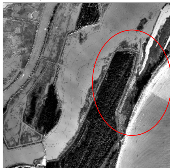
Fig.5 –Riprese aeree Costa 1991 (sx) e Costa 1992 (dx). Si nota come le zone prospicienti l'argine sono in erosione/abbassamento.
