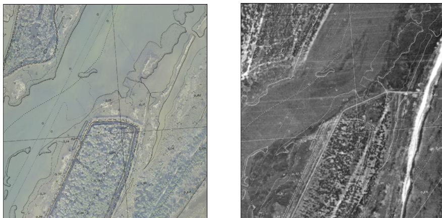
Figura 4.2- Confronto tra la restituzione fotogrammetrica della situazione attuale (rilievo 2019) con il rilievo del 1954 (volo GAI) su base CTR 1:5.000 di riferimento.
