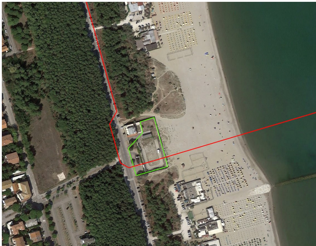
Figura 8-1 in verde l'area di lavoro per postazione di spinta microtunnel a Ravenna, in rosso il metanodotto in progetto
