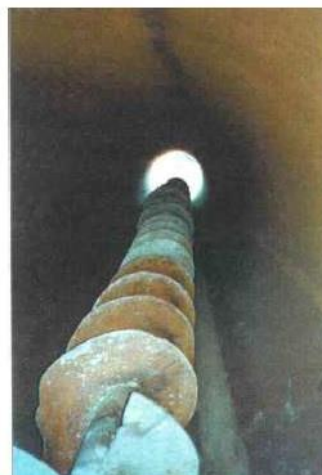
Figura 2-14: Coclea di una spingitubo
