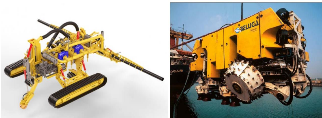
Figura 2-8: Esempio di Mezzo Sottomarino Tradizionale per Operazione di Interramento della Condotta con Post Trenching
