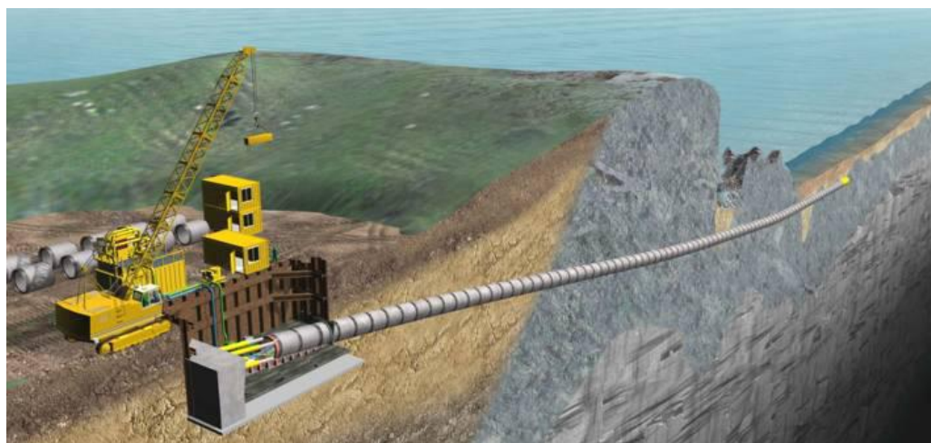
Figura 2-12: Fase di scavo del microtunnel
