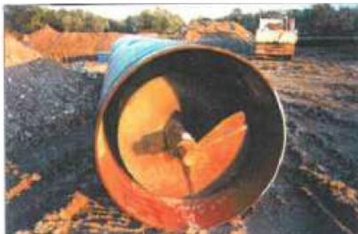
Figura 2-14: Coclea di una spingitubo
