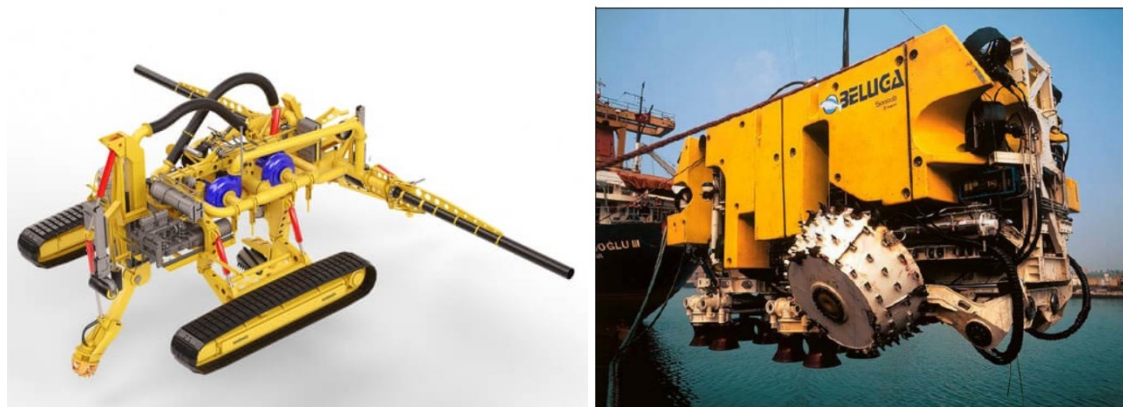
Figura 4.4: Esempio di Mezzo Sottomarino Tradizionale per Operazione di Interrimento della Condotta con Post Trenching
