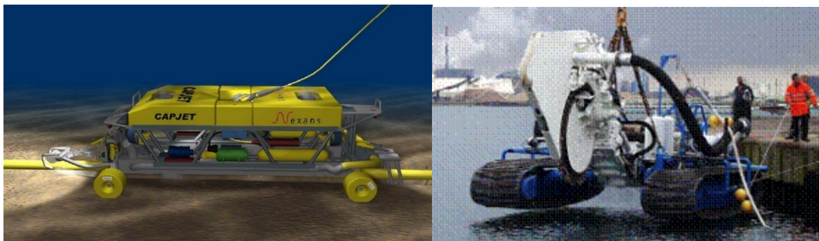
Figura 4.6: Esempio di mezzi sottomarini per interrimento di cavi
