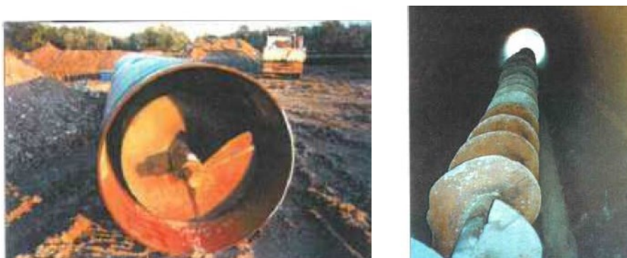
Figura 4.10: Coclea di una spingitubo
