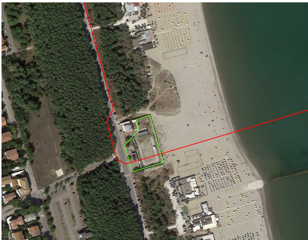
Figura 4.7: in verde l'area di lavoro per postazione di spinta microtunnel a Ravenna, in rosso il metanodotto in progetto
