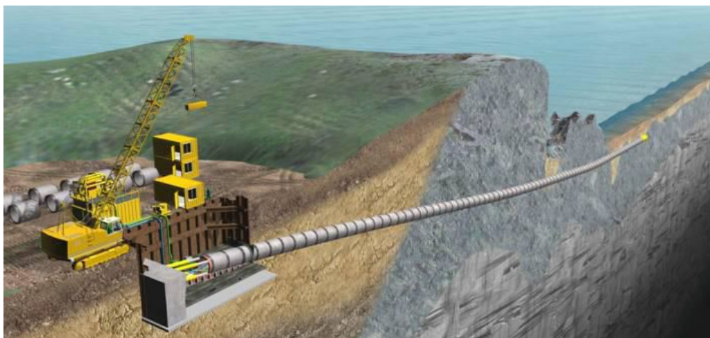
Figura 4.8: Fase di scavo del microtunnel
