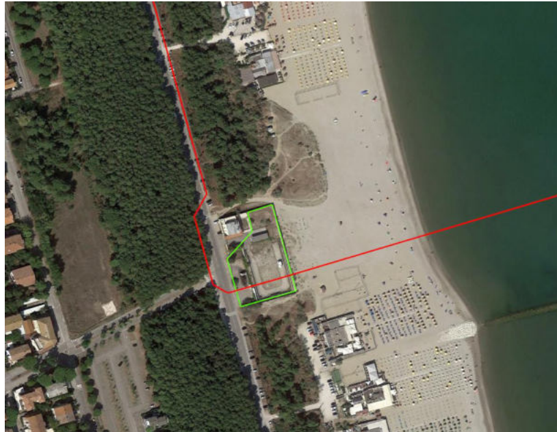
Figura 7.3: In verde l'area di lavoro per postazione di spinta microtunnel a Ravenna, in rosso il metanodotto in progetto
