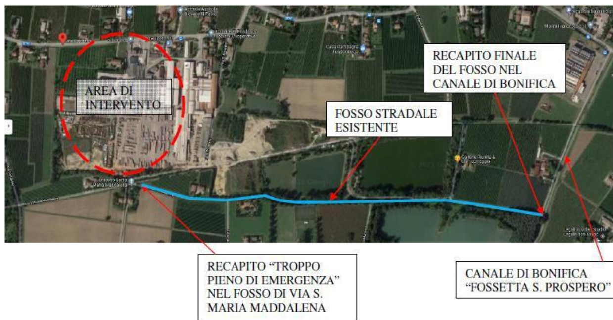
Figura 8 - cartografia di percorso delle acque bianche di "troppo pieno"
