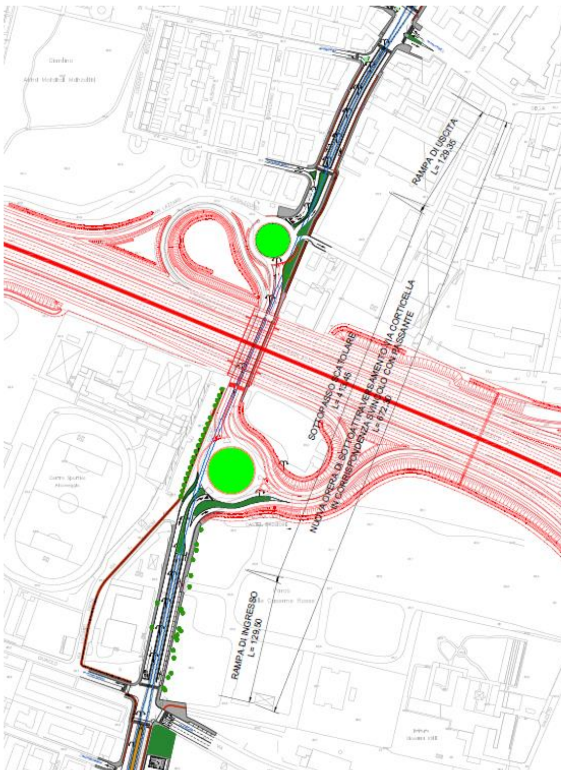
Figura 3.5 –Nuova configurazione svincolo Passante Tangenziale di Bologna (rosso) su via Corticella e nuovo sottovia tranviario
