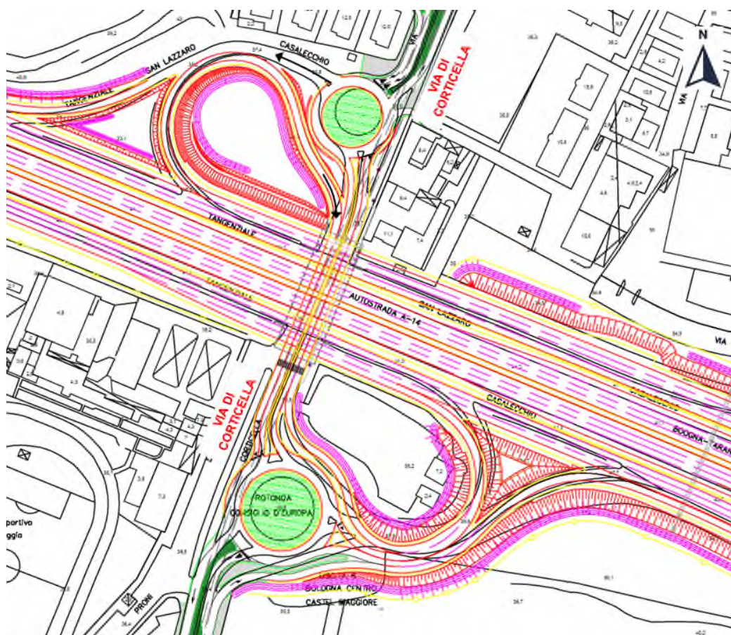
Figura 5.3: Particolare del progetto dello svincolo della tangenziale Nord su Via di Corticella.
