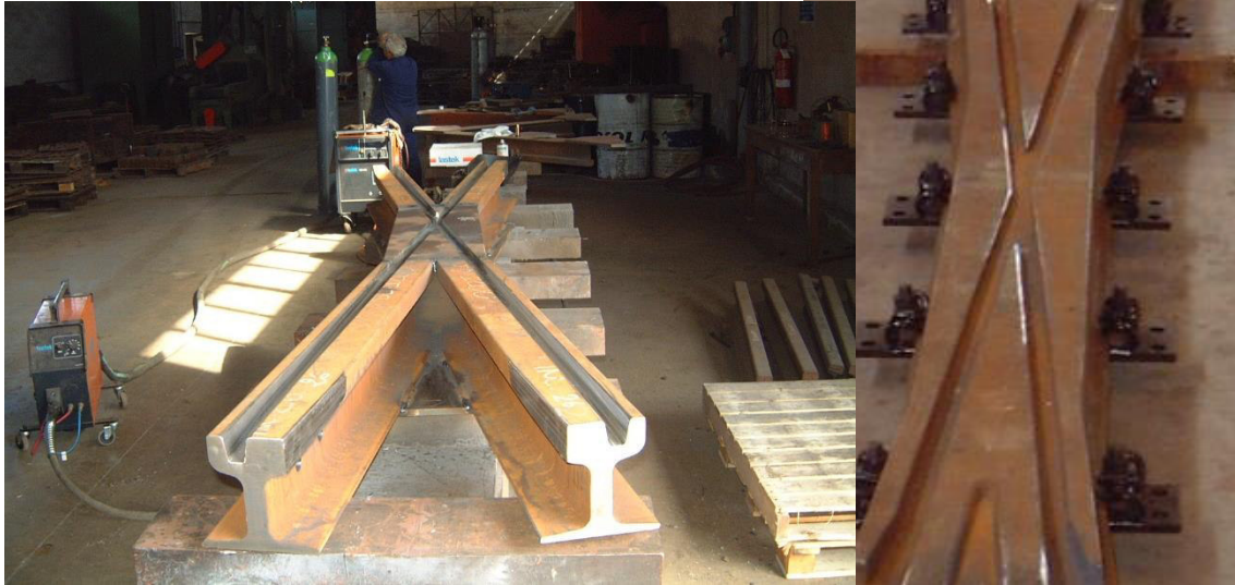
VISTA DI INCROCIO TRANVIARIO IN FASE DI LAVORAZIONE
