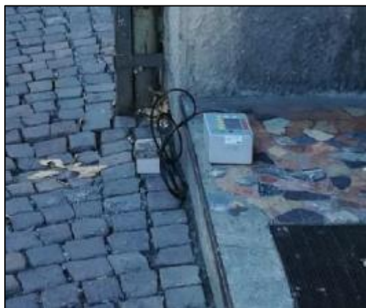
Figura 4-44 – Posizionamento attrezzatura per esecuzione misura vibrazioni
