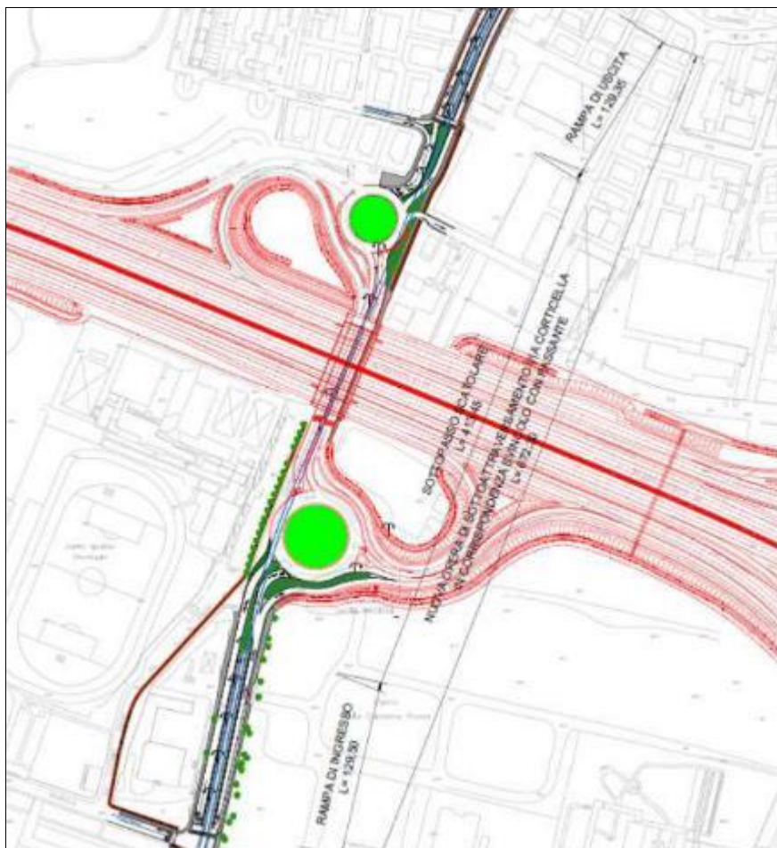
Figura 2-45 – Nuova configurazione svincolo Passante Tangenziale di Bologna (rosso) su via Corticella e nuova sottovia tranviaria
