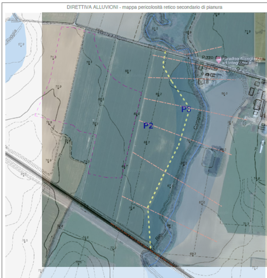
Fig 5.2 – Sovrapposizione tra la mappa di pericolosità per il reticolo secondario di pianura e il limite dell'area allagata calcolata dal presente studio idraulico
