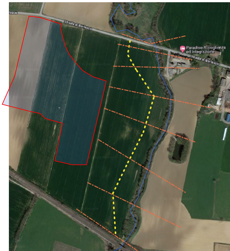
Fig 5.3 – Individuazione della linea di confine dell’area allagata in sponda sinistra (linea gialla tratteggiata) risultante dalle simulazioni delle piene con T = 100 anni e T = 200 anni (la sezione di monte è la n. 10 e quella di valle è la n. 3. La linea dell’alveo è derivata dallo shapefile della Regione Emilia-Romagna. Foto aerea da Google)
