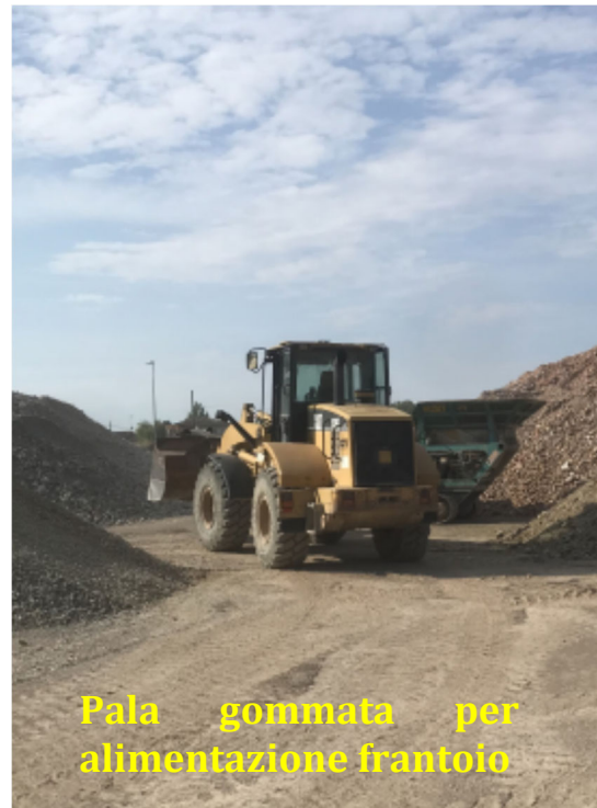
Fig. 2 – Foto scattate all’atto dei rilievi presso l’area di pertinenza della Ditta Scaravelli Carlo di Scaravelli Lindo, ove è rappresentata la sorgente rumorosa ( S ) costituita dal frantoio mobile in postazione fissa al centro del piazzale, con pala gommata per movimentazione e del materiale da frantumare e alimentazione del frantoio.
