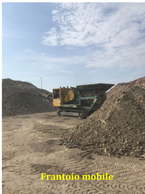
Fig. 2 – Foto scattate all’atto dei rilievi presso l’area di pertinenza della Ditta Scaravelli Carlo di Scaravelli Lindo, ove è rappresentata la sorgente rumorosa ( S ) costituita dal frantoio mobile in postazione fissa al centro del piazzale, con pala gommata per movimentazione e del materiale da frantumare e alimentazione del frantoio.
