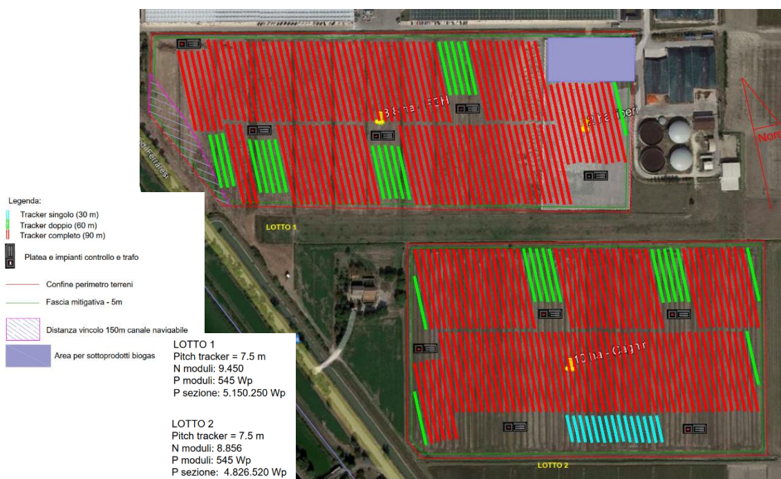
Figura 5 – Vista planimetrica dell'impianto agrovoltaico in progetto
