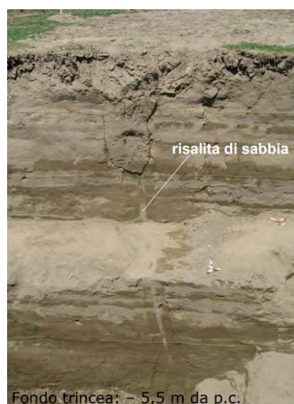
Figura 6-7 – Foto fenomeno di liquefazione nell'area dell'alto ferrarese a seguito dei terremoti del 20 e 29 Maggio 2012
