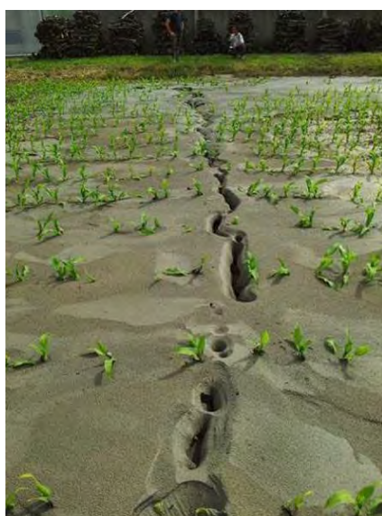
Figura 6-7 – Foto fenomeno di liquefazione nell'area dell'alto ferrarese a seguito dei terremoti del 20 e 29 Maggio 2012
