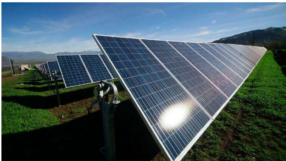
Figura 4: Esempio di tracker monoassiale
