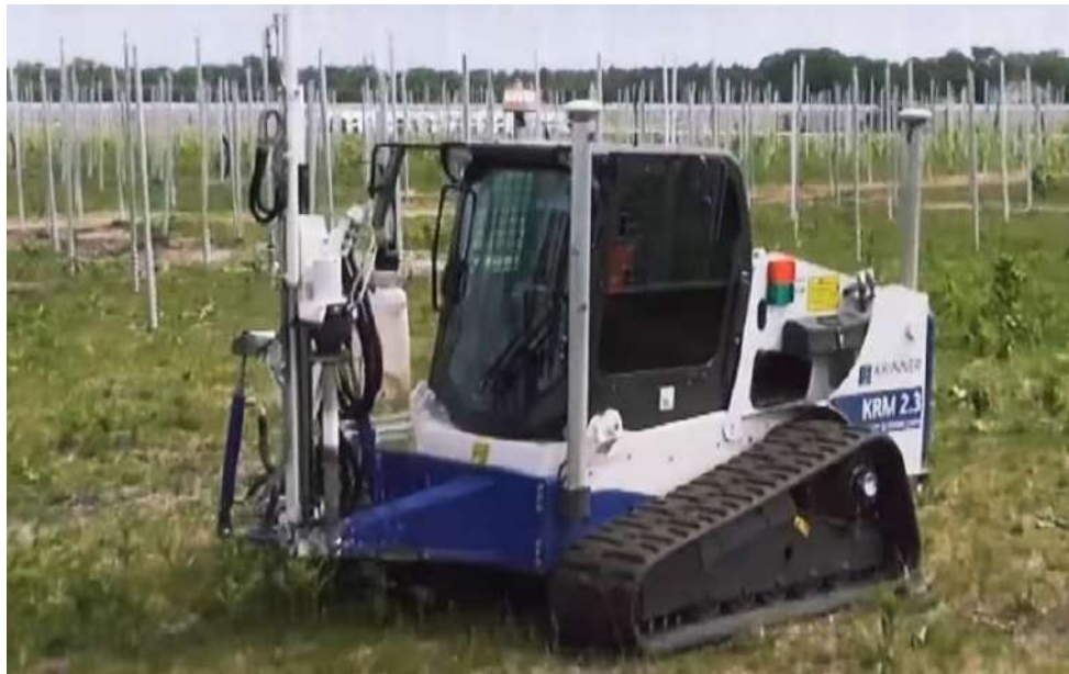
Figura 6 - Esempio di fissaggio delle strutture di supporto
