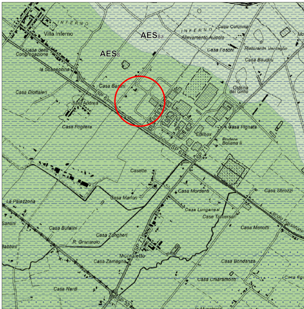
Figura n. 8 - Estratto della Carta Geologica in scala 1:10.000 dal Sito della cartografia geologica del Servizio Geologico, Sismico e dei Suoli, Regione Emilia-Romagna. L'area in esame e la zona di pertinenza ricadono in un affioramento del Subsistema di Ravenna (AES 8 ).
