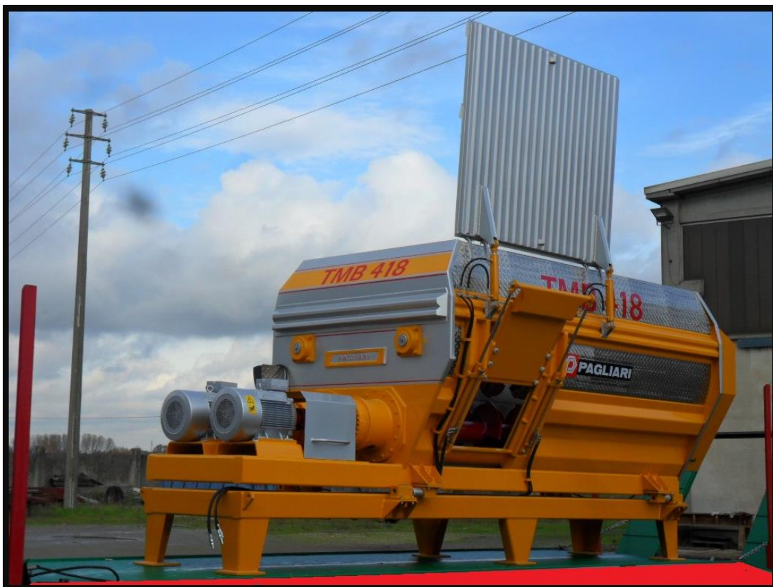
Figura 7: Immagine di trinciamiscelatore fisso per produzione gessi di defecazione
