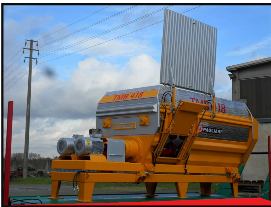
Figura 7: Immagine di trinciamiscelatore fisso per produzione gessi di defecazione
