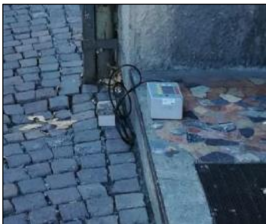
Figura 4-32 – Posizionamento attrezzatura per esecuzione misura vibrazioni
