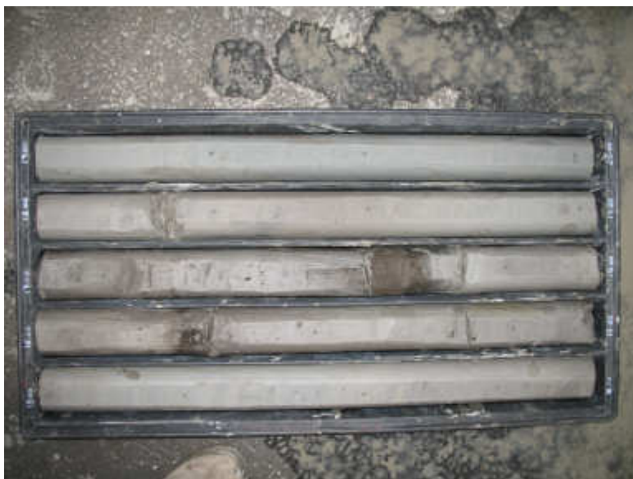
Cassetta catalogatrice Sondaggio a carotaggio continuo S1 da 15.0 a 20.0 m di profondità
