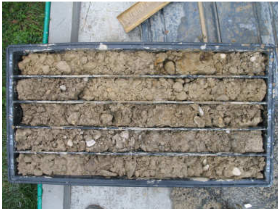
Cassetta catalogatrice Sondaggio a carotaggio continuo S3 da 25.0 a 30.0 m di profondità
