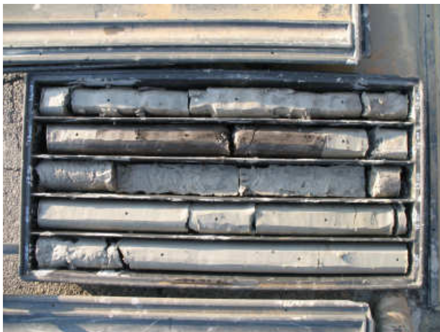
Cassetta catalogatrice Sondaggio a carotaggio continuo S4 da 10.0 a 15.0 m di profondità
