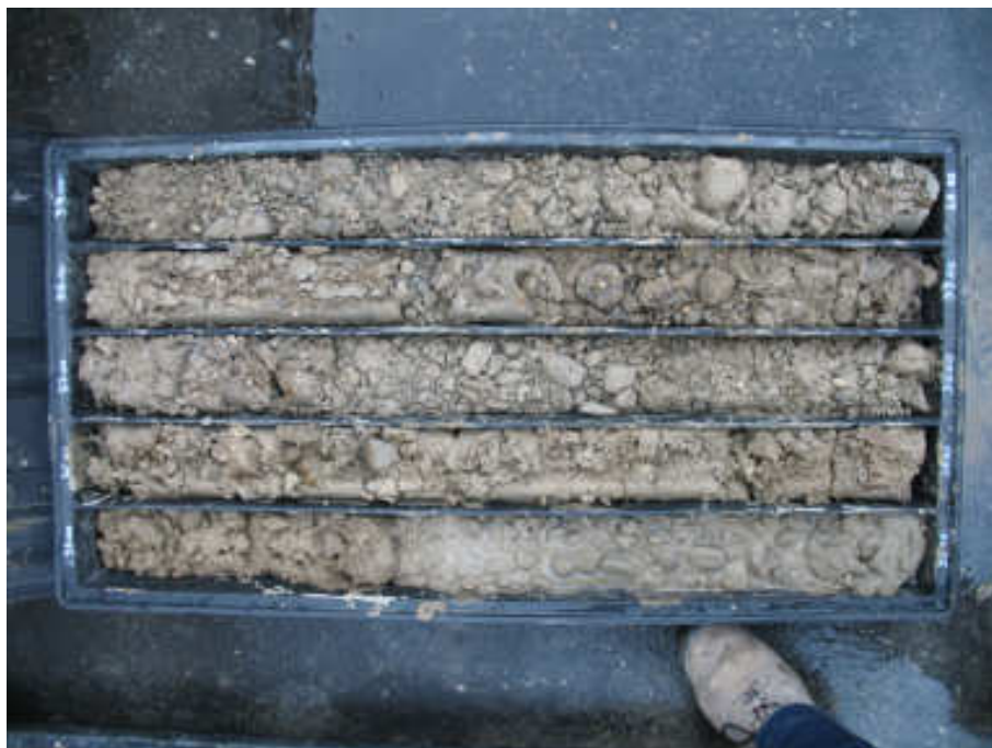
Cassetta catalogatrice Sondaggio a carotaggio continuo S1 da 35.0 a 40.0 m di profondità
