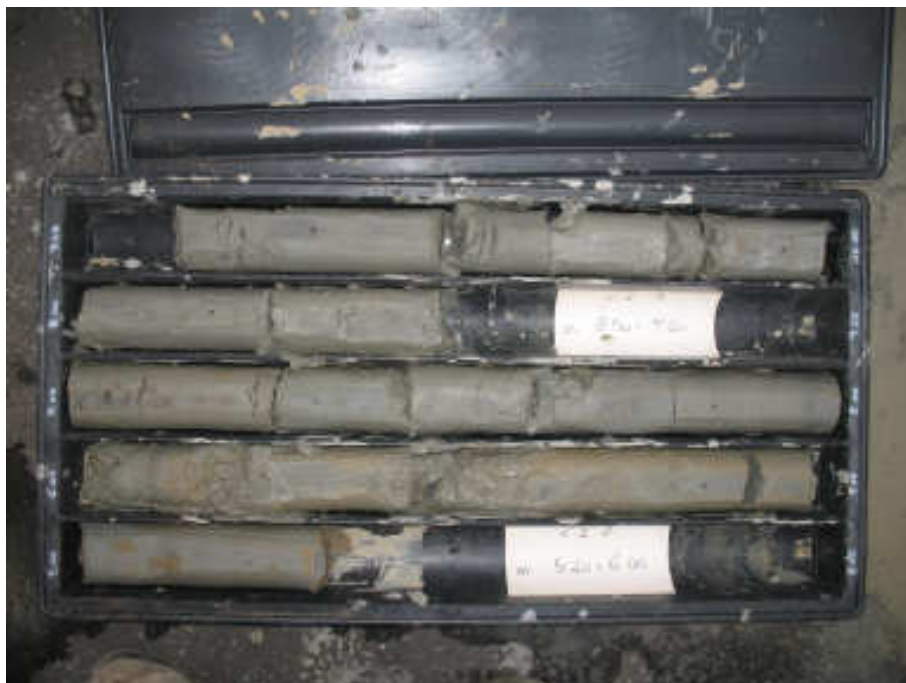
Cassetta catalogatrice Sondaggio a carotaggio continuo S1 da 5.0 a 10.0 m di profondità
