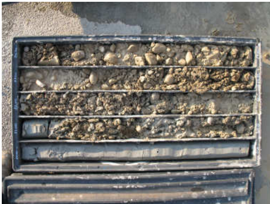
Cassetta catalogatrice Sondaggio a carotaggio continuo S4 da 20.0 a 25.0 m di profondità
