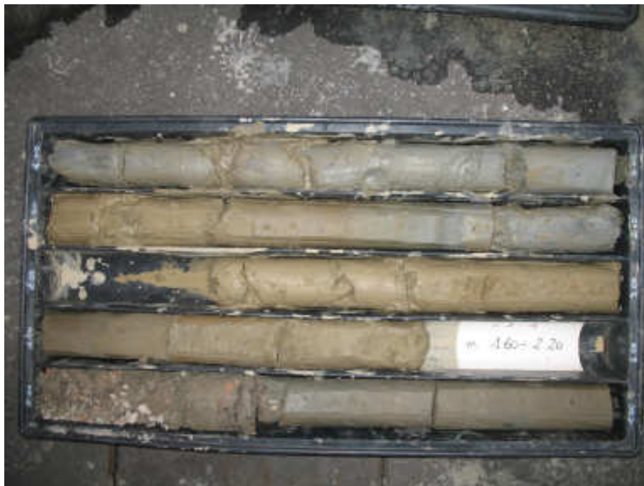
Cassetta catalogatrice Sondaggio a carotaggio continuo S1 da p.c. a 5.0 m di profondità
