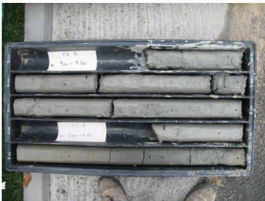
Cassetta catalogatrice Sondaggio a carotaggio continuo S3 da 5.0 a 10.0 m di profondità
