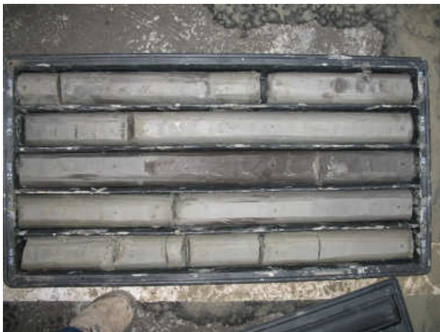
Cassetta catalogatrice Sondaggio a carotaggio continuo S1 da 10.0 a 15.0 m di profondità
