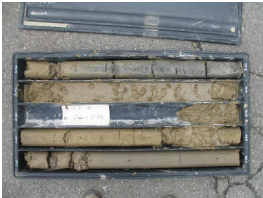
Cassetta catalogatrice Sondaggio a carotaggio continuo S4 da p.c. a 5.0 m di profondità
