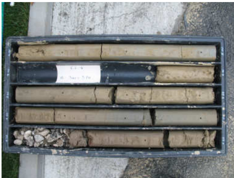
Cassetta catalogatrice Sondaggio a carotaggio continuo S3 da p.c. a 5.0 m di profondità
