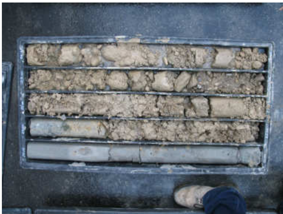
Cassetta catalogatrice Sondaggio a carotaggio continuo S1 da 20.0 a 25.0 m di profondità
