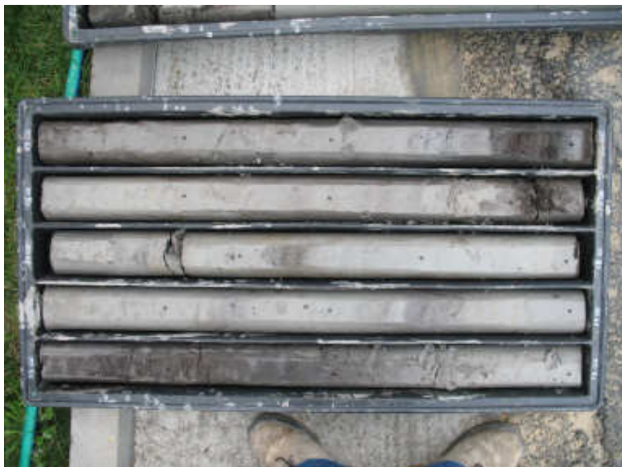
Cassetta catalogatrice Sondaggio a carotaggio continuo S3 da 15.0 a 20.0 m di profondità
