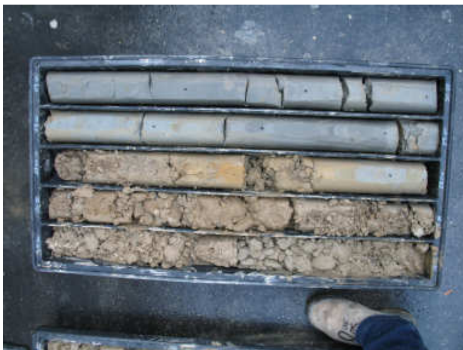
Cassetta catalogatrice Sondaggio a carotaggio continuo S1 da 25.0 a 30.0 m di profondità
