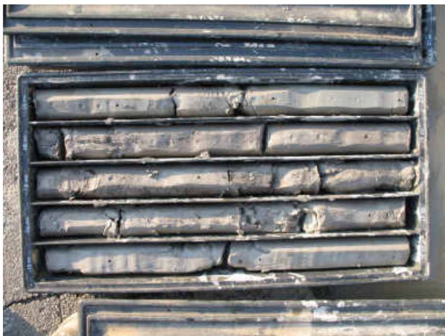
Cassetta catalogatrice Sondaggio a carotaggio continuo S4 da 15.0 a 20.0 m di profondità
