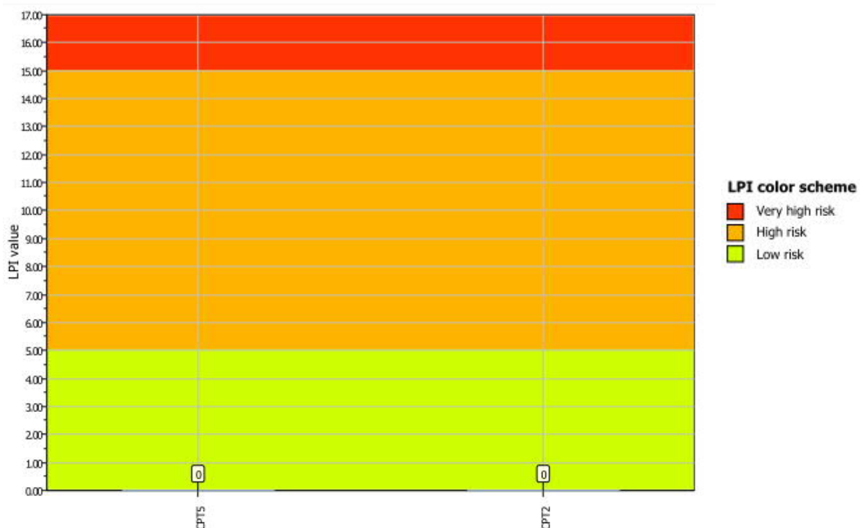
FIGURA 37 – GRAFICO CON ESPRESSI I VALORI DI LPI PER OGNI PROVA
