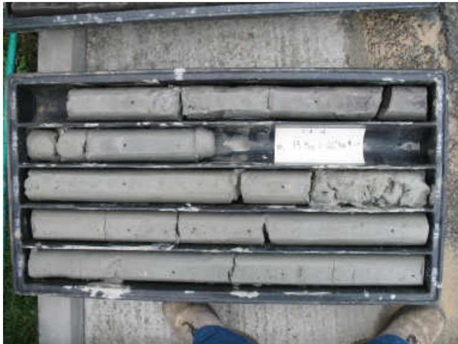
Cassetta catalogatrice Sondaggio a carotaggio continuo S3 da 10.0 a 15.0 m di profondità
