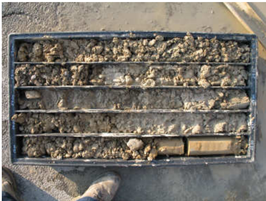
Cassetta catalogatrice Sondaggio a carotaggio continuo S4 da 25.0 a 30.0 m di profondità
