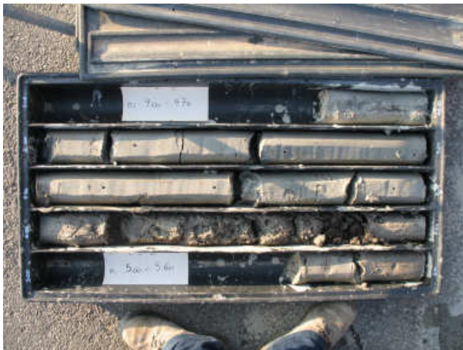
Cassetta catalogatrice Sondaggio a carotaggio continuo S4 da 5.0 a 10.0 m di profondità
