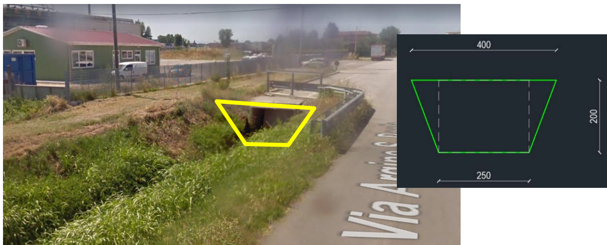
Figura 17 - Sezione del Canale Treppiede in corrispondenza della chiusura del bacino considerato
