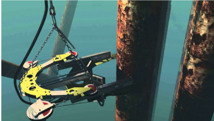
Fig.4: Immagine esemplificativa del sistema di taglio subacqueo
