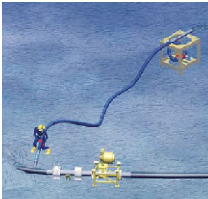
Fig. 3: Attività di scoprimento della condotta
