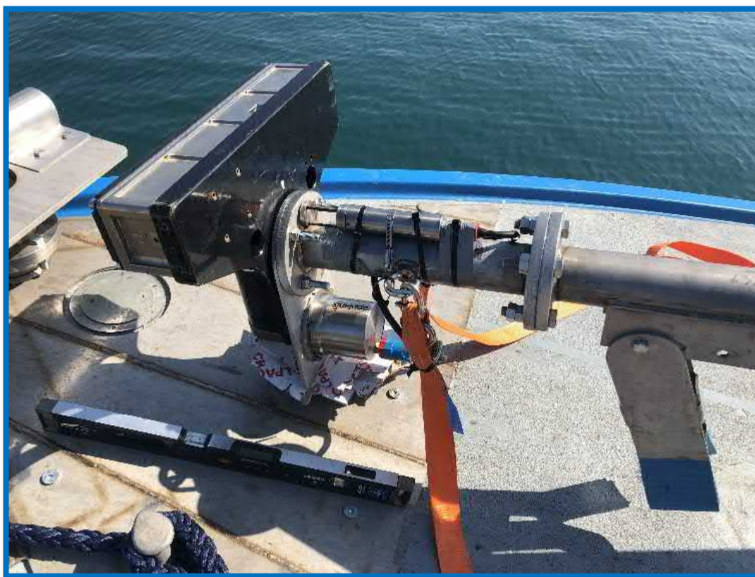
Figura 260. installazione sistema MBES a bordo della M/B Maestrale Primo.
