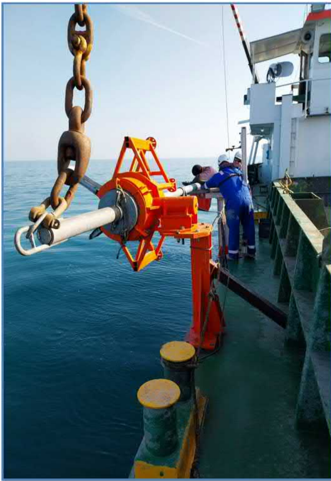
Figura 22. Carotiere a gravità
