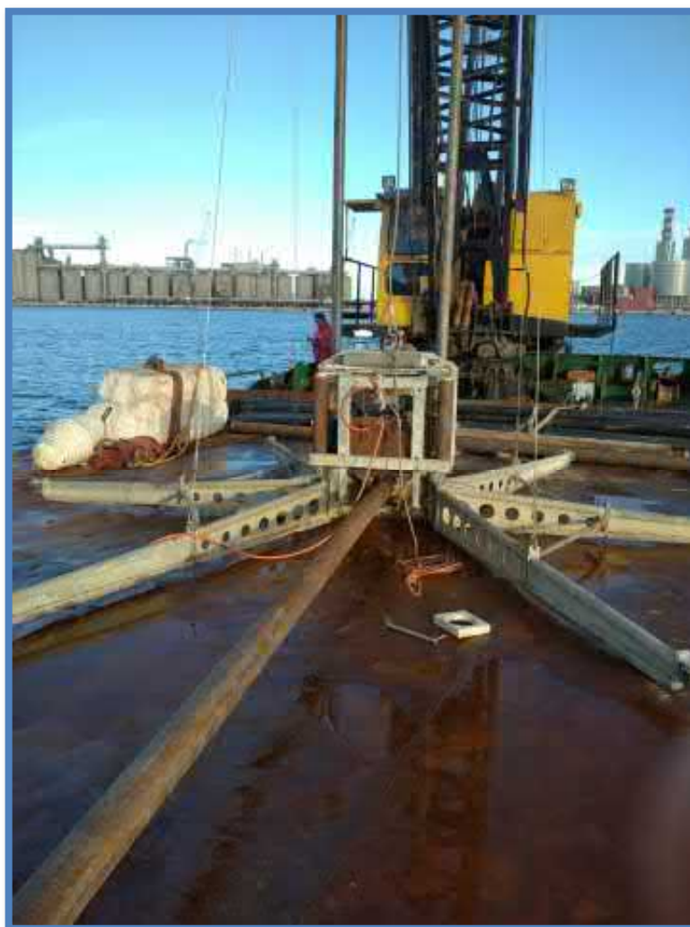
Figura 24. Vibrocarotiere
