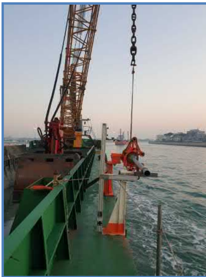
Figura 23. Carotiere a Gravità posizionato all'interno del sistema di brandeggio
