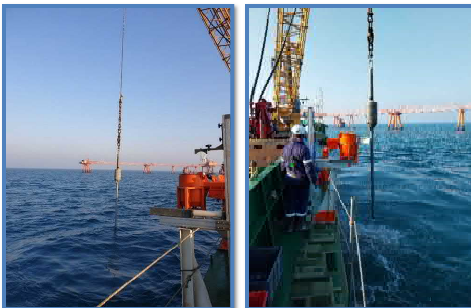
Figura 21. Carotiere a gravità
