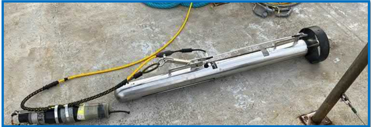
Figura 265. Side Scan Sonar
