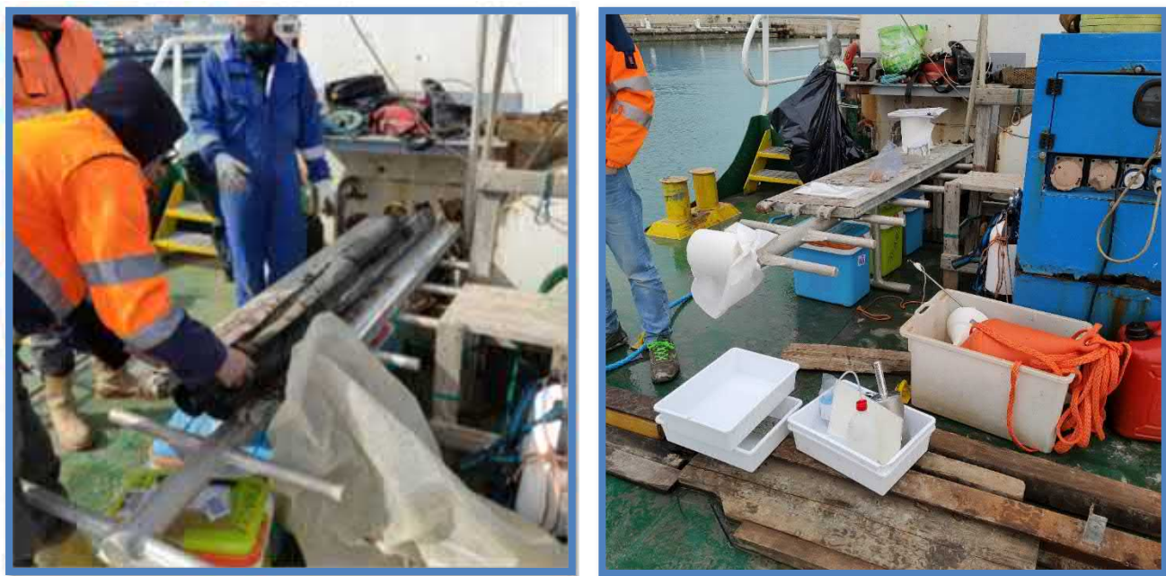
Figura 8. Fase di apertura della carota
