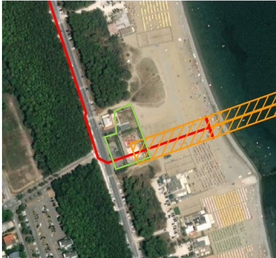
Figura 7.19: In verde l'area di lavoro per postazione di spinta microtunnel a Ravenna, in rosso il metanodotto in progetto
