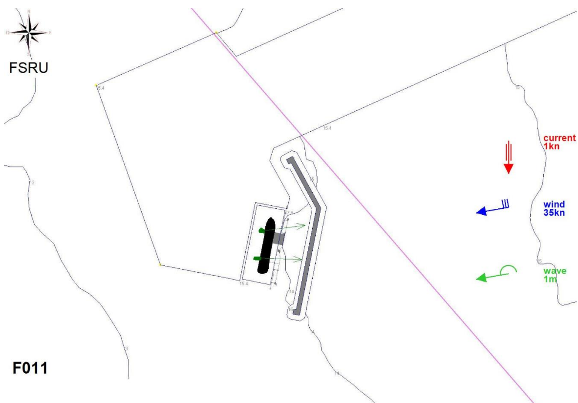
Fig. A - 2 – Manovra F011 – FSRU - Partenza – TEST Levante 35 nodi.
