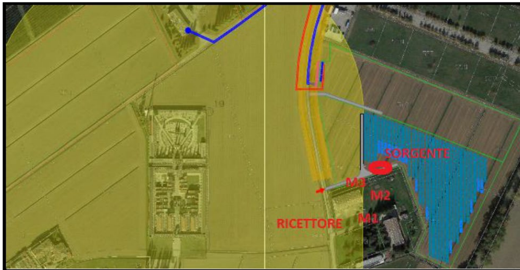
Figura 84: Individuazione sorgenti sonore Ricettore sensibile e punti di misura M1 M2 M3
