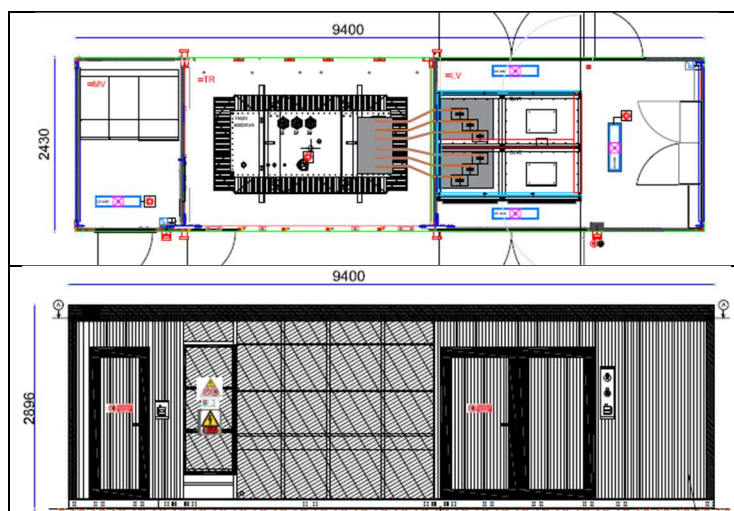
Figura 4 – Pianta e prospetto delle cabine di trasformazione
