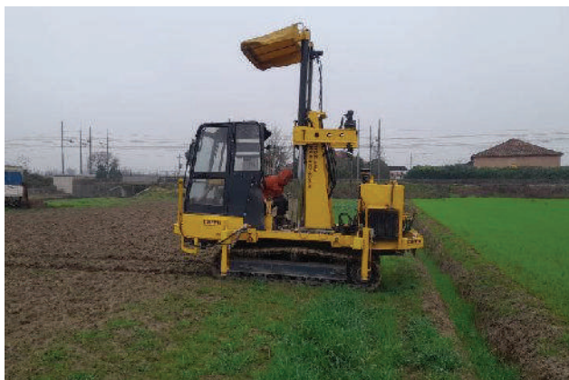
Figura 5-2 - Mezzo utilizzato per le prove CPTU
