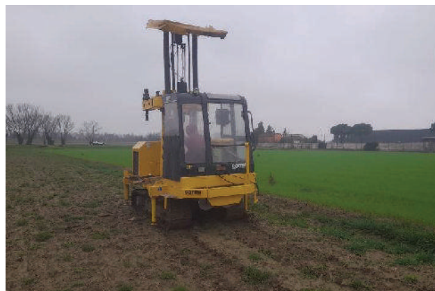
Figura 5-2 - Mezzo utilizzato per le prove CPTU
