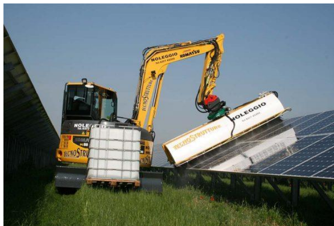
Esempio di sistema di lavaggio moduli fotovoltaici
