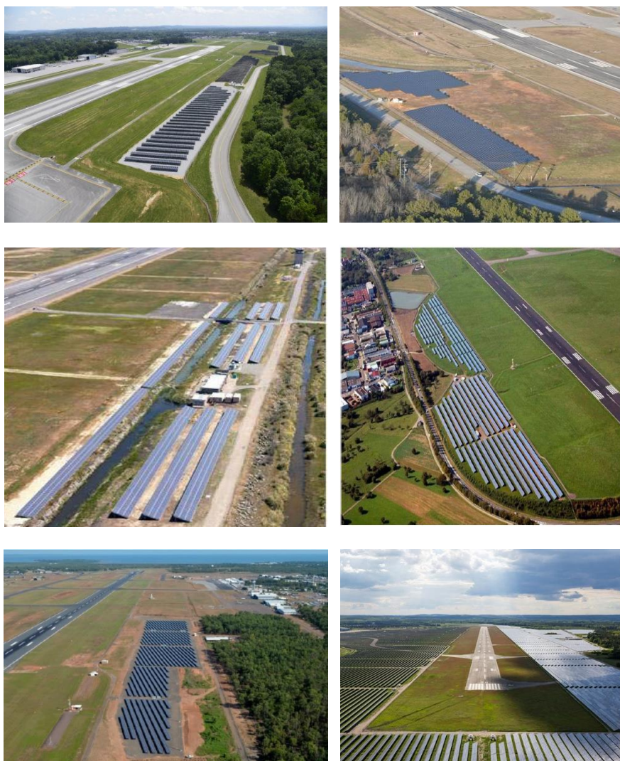
Figura: Esempi di impianti fotovoltaici in ambito aeroportuale. La disposizione dei moduli fotovoltaici in prossimità delle piste di atterraggio/decollo non rappresenta un rischio per la sicurezza
