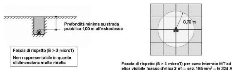
Img. 10.2 - Estratto Linee guida Enel Distribuzione S.p.A. relativo a linea MT interrata in cavo cordato a elica
