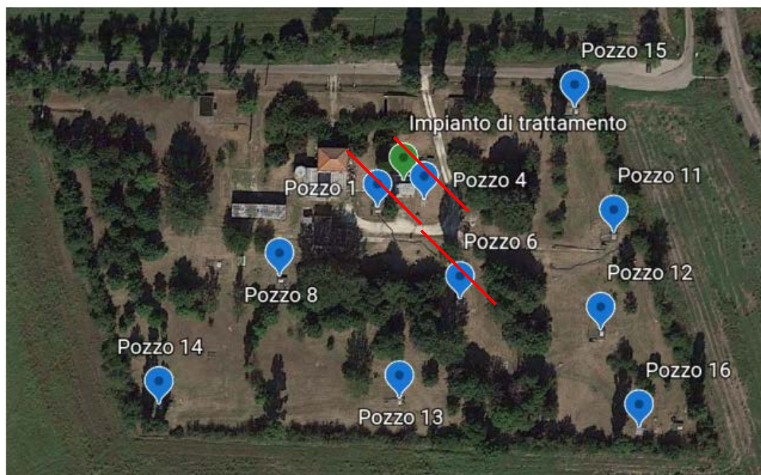
Figura 2-Campo pozzi di Bosco Fontana (i lati verticali dell'immagine sono orientati all'incirca SO-NE, con il Nord in alto). Le Barre rosse identificano i pozzi che dovrebbero essere sostituiti dalle coppie di pozzi monofalda da realizzare (Figura 1).
