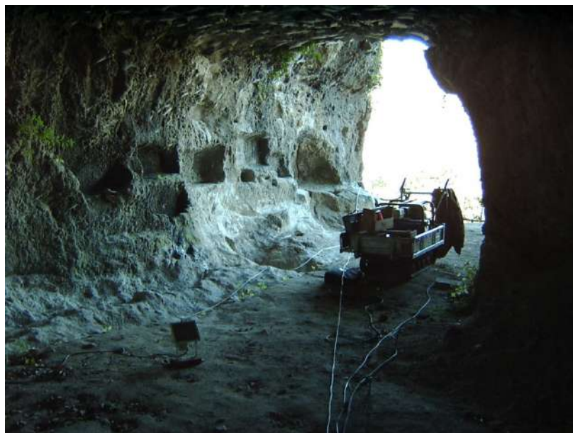
Figura 2-18 Prospezioni geoelettriche (tomografia) ingresso grotta Re Tiberio
