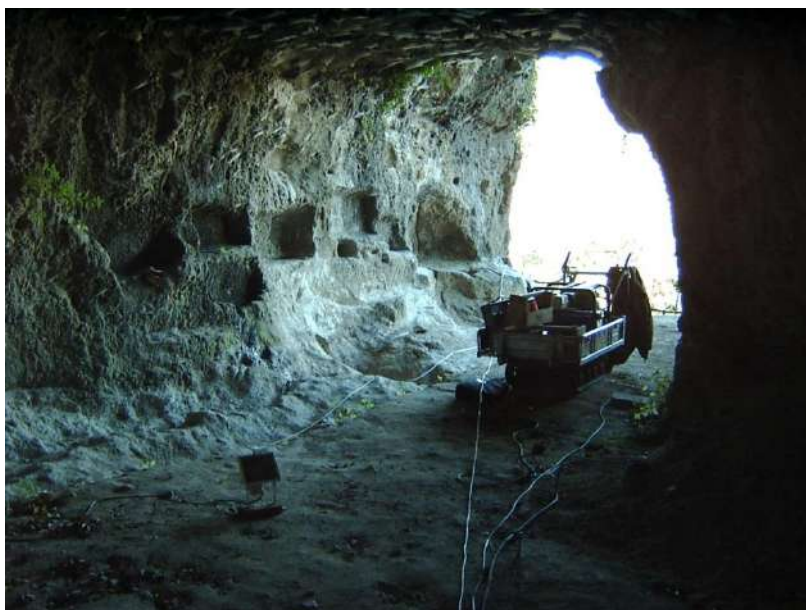
Foto 5: Prospezioni geoelettriche (tomografia) ingresso grotta Re Tiberio
