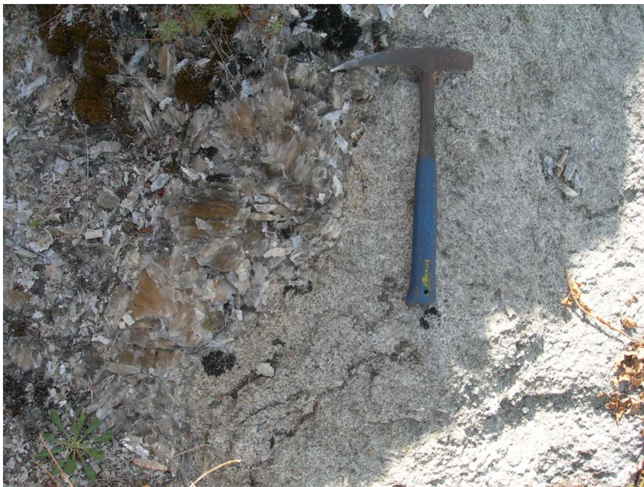
FOTO 5 – LOCALITÀ “CEPETO”. IN FIGURA SONO BEN EVIDENTI I CRISTALLI DI GESSO MICROCRISTALLINO, DOVUTI ESSENZIALMENTE AL CAMPO DI STRESS A CUI SONO STATI SOTTOPOSTI, ED I CRISTALLI DI GESSO MACROCRISTALLINI, DOVUTI ESSENZIALMENTE AL RIEMPIMENTO DI FRATTURE.
