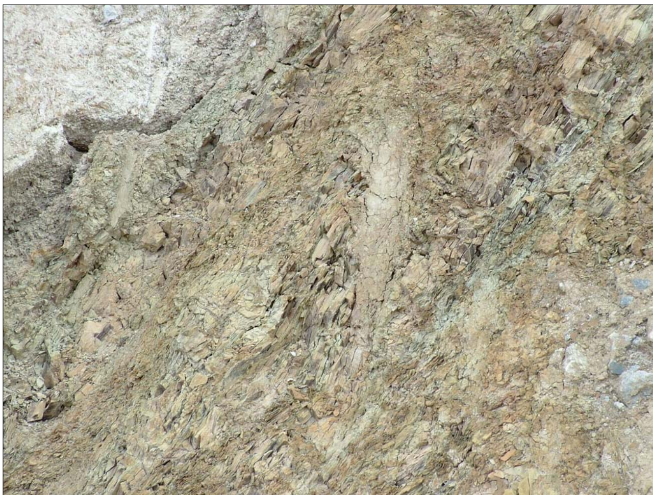
FOTO 18,19,20 - intercalazioni marnose all'interno dei gessi affioranti sul versante Nord all'interno del fronte della cava in esercizio
