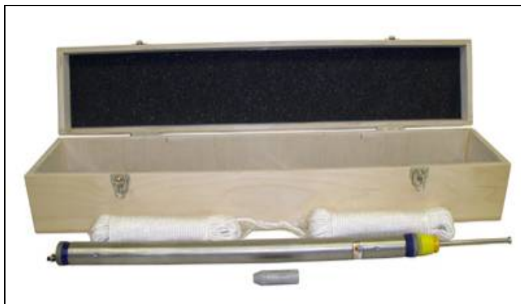
Figura 3.3.1 – A sinistra disegno schematico-descrittivo di un bailer riutilizzabile in acciaio, a destra la foto del medesimo strumento
