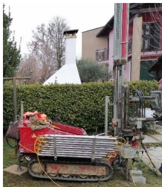
Fig. 3.2 – Penetrometro TG63-200
