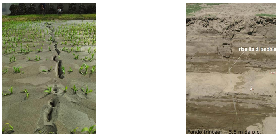
Fig. 2.6 – Foto fenomeno di liquefazione nell'area dell'alto ferrarese a seguito dei terremoti del 20 e 29 Maggio 2012
