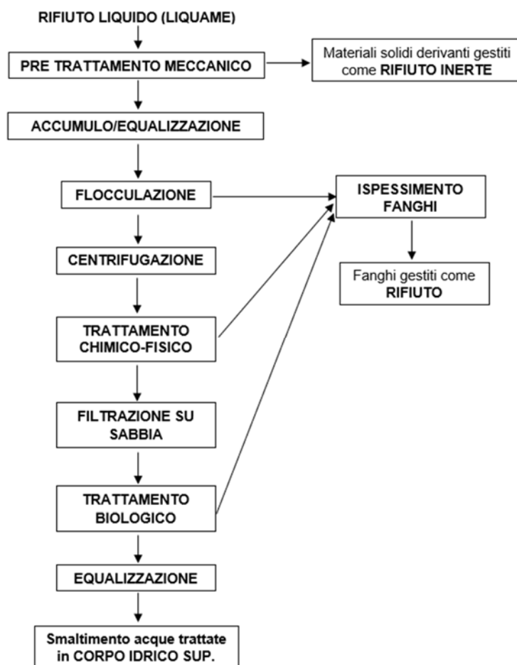
Fig. 8.5 – Schema a blocchi trattamento rifiuti liquidi
