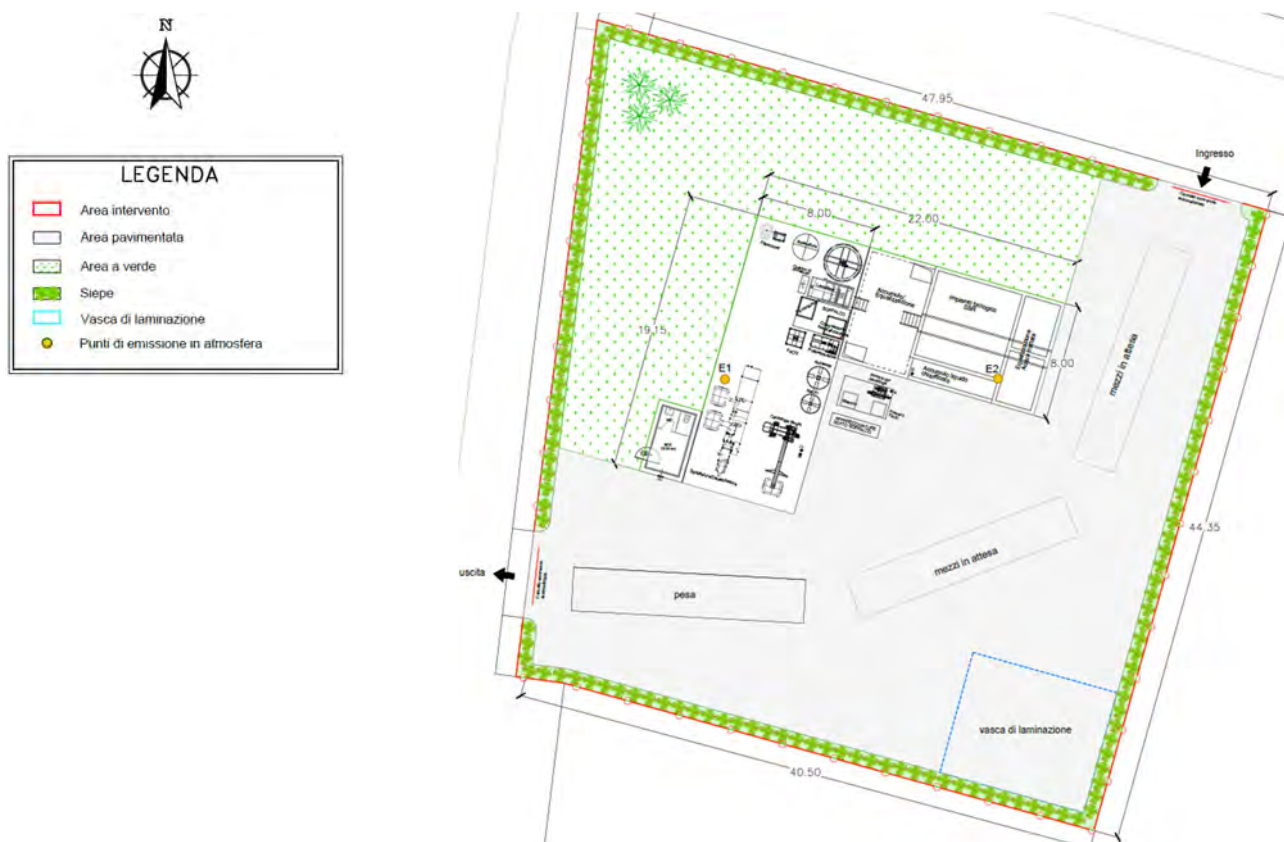
Fig. 5.1 – Individuazione emissioni in atmosfera e fascia perimetrale a verde
