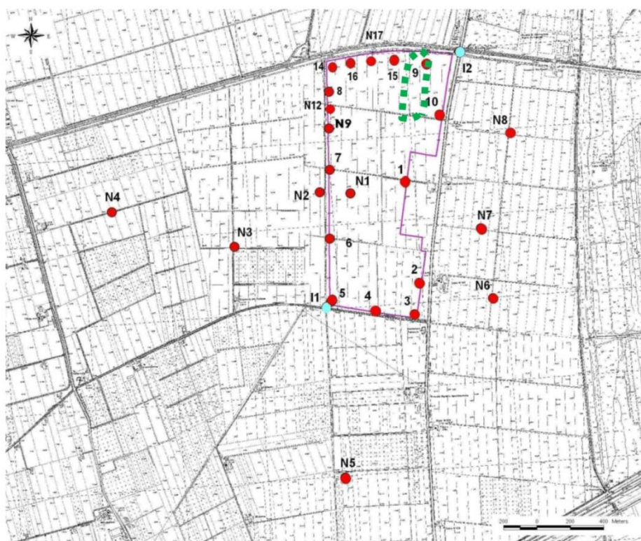
Figura 17: Planimetria con ubicazione di pozzi e piezometri utilizzati per la piezometria del comparto HERA (in viola il perimetro del comparto Hera)
