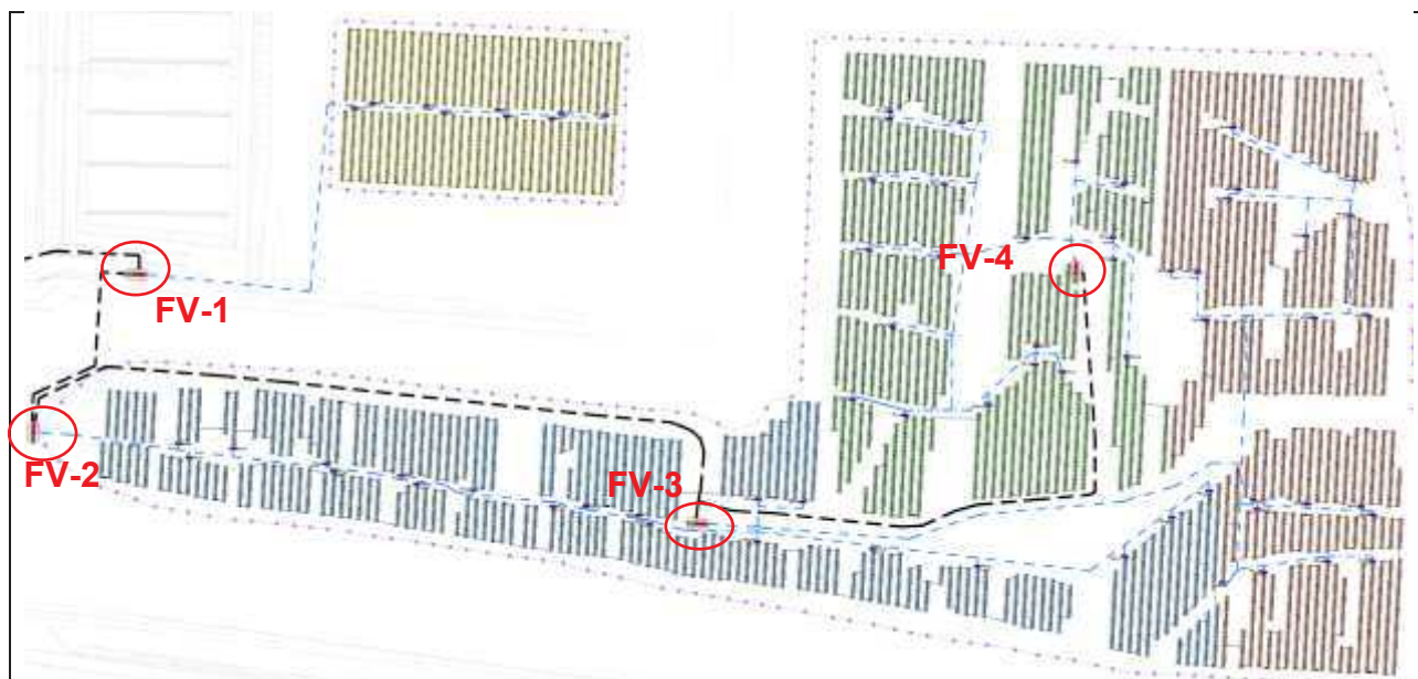
Figura 7 – Posizione delle cabine di campo
