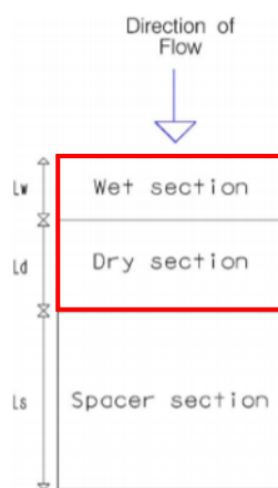
Figura 7.11: Modulo tipo, descrivente il modello concettuale idrologico dell'installazione di strutture fotovoltaiche a tracker su pali infissi comprendente l'area pannelli (in rosso) e l'area di interfila (Fonte: Hydrologic response of solar farm Cook 2013 American Society of Civil Engineers).
