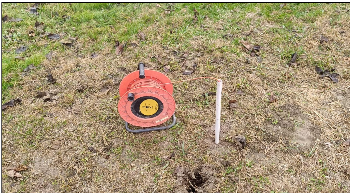
Figura 3.6. Installazione piezometro temporaneo
