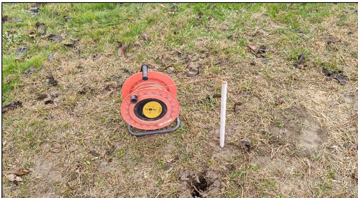
Figura 3.6. Installazione piezometro temporaneo
