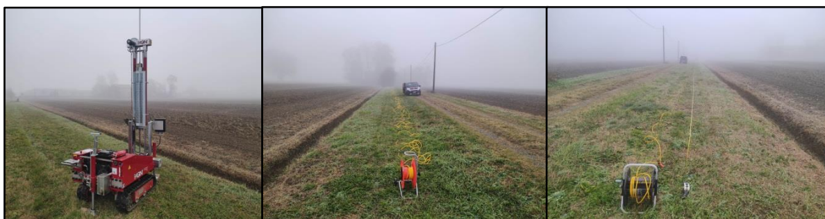
Figura 5.1: Indagini geognostiche: prova penetrometrica, prospezione geofisica MASW e tomografia geoelettrica
