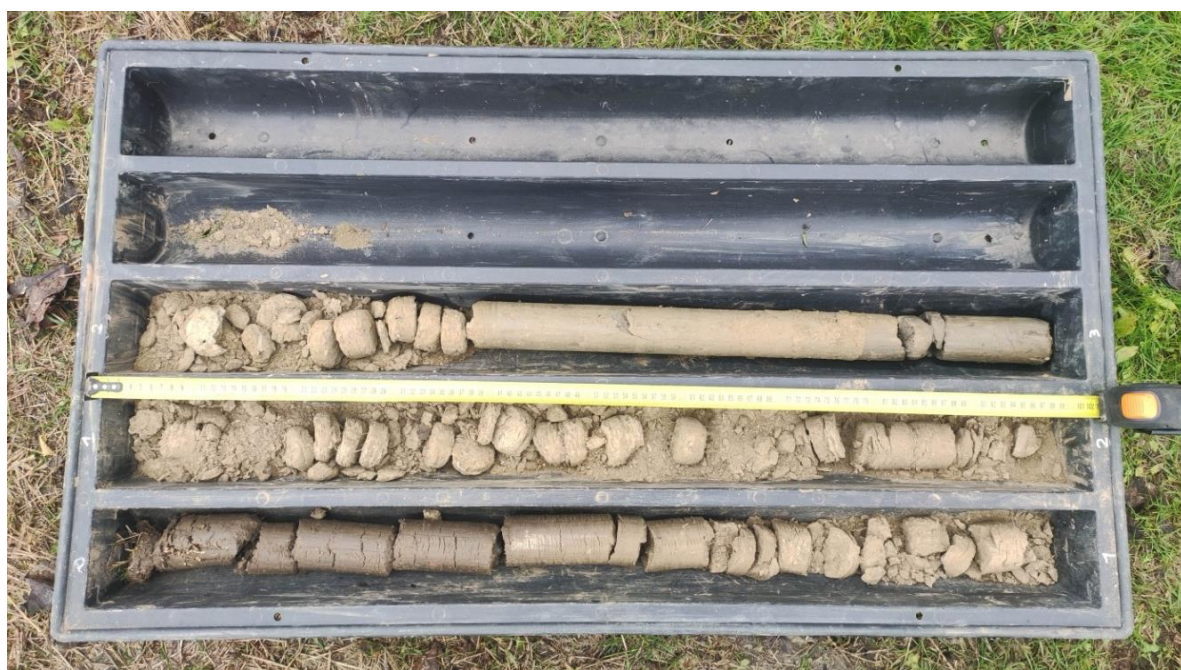
Figura 4.1: Cassetta del sondaggio a percussione (S1)
