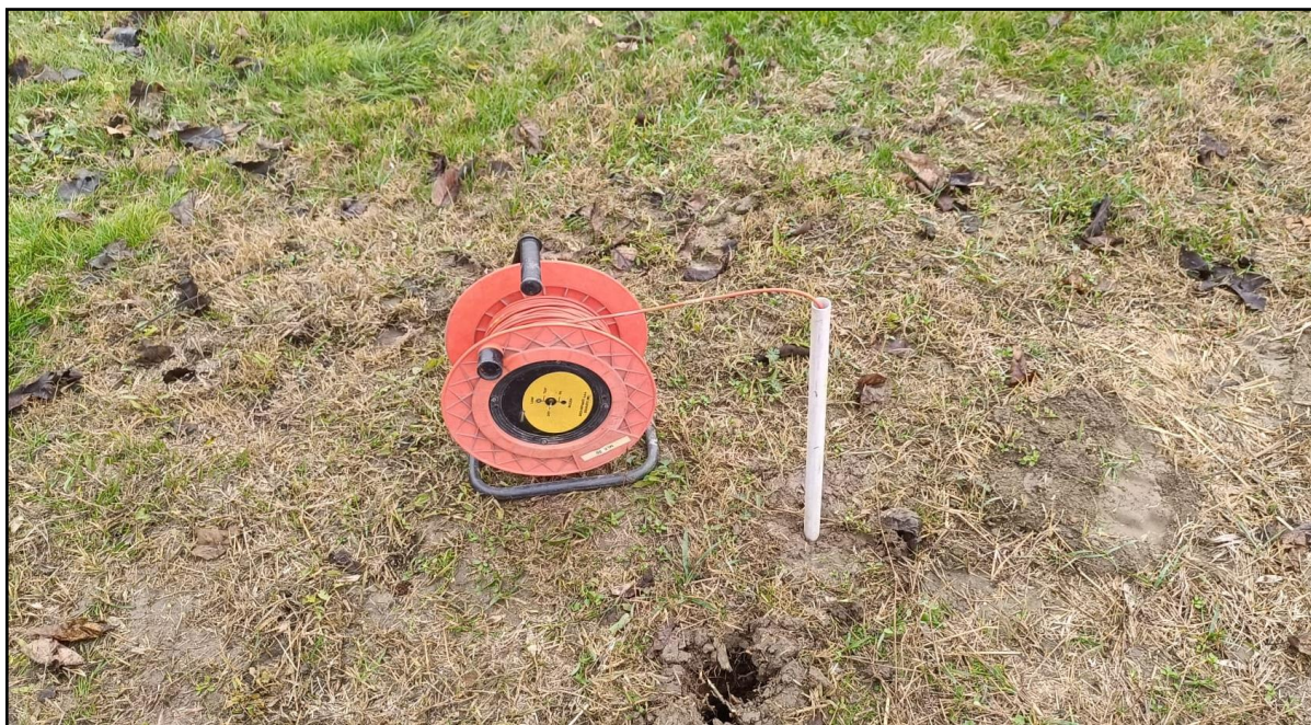
Figura 6.35. Installazione piezometro temporaneo
